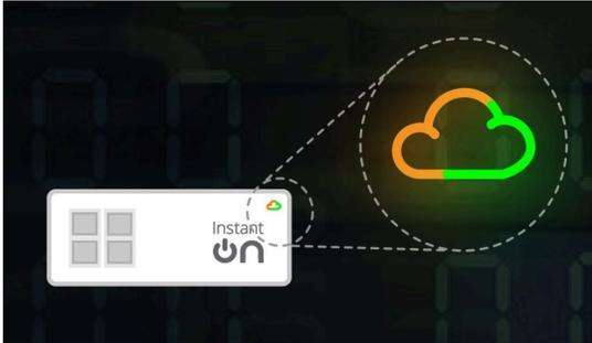
Um diagrama que mostra um switch branco Aruba Instant On com o logotipo 'Instant On' na frente. Uma luz de LED na nuvem do switch está alternando entre verde e amarelo. Um círculo tracejado ao redor da luz indica o status de descoberta. |
