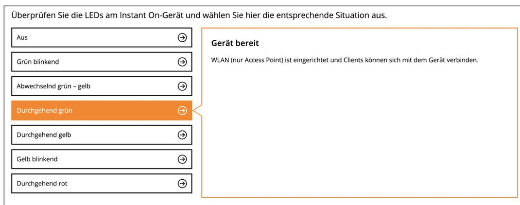
5. Überprüfen Sie die LEDs auf dem Instant On und wählen Sie auf die entsprechende Situation im Assistenten für die Fehlerbehebung. Der Assistent empfiehlt eine Fehlerbehebungsaktion, um die Meldung zu beheben.
