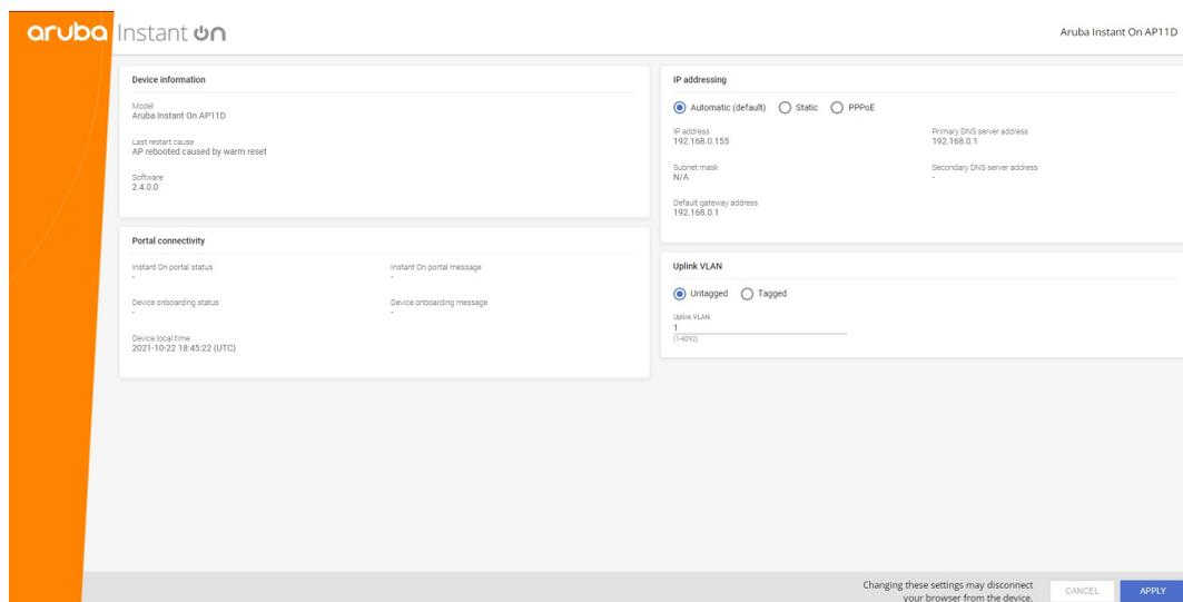
À partir de Instant On 2.4.0, il est possible de baliser le VLAN de liaison montante du point d'accès. Par défaut, le VLAN de liaison montante n'est pas balisé avec VLAN ID 1. Cela peut désormais être remplacé par un VLAN balisé utilisant un autre ID, compris entre 1 et 4 092.
